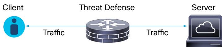
(正常に TCP 3 ウェイハンドシェイクが完了した後) クライアントがサーバーとの TCP 接続を確立すると、管理対象デバイスは TCP セッションでの暗号化されたセッションの開始の試行をモニターします。TLS/SSL ハンドシェイクは、クライアントとサーバー間の特殊なパケットの交換を利用して、暗号化セッションを確立します。SSL と TLS プロトコルでは、これらの特殊なパケットはハンドシェイク メッセージと呼ばれます。ハンドシェイク メッセージは、クライアントとサーバーの両方がサポートする暗号化属性を伝えます。
