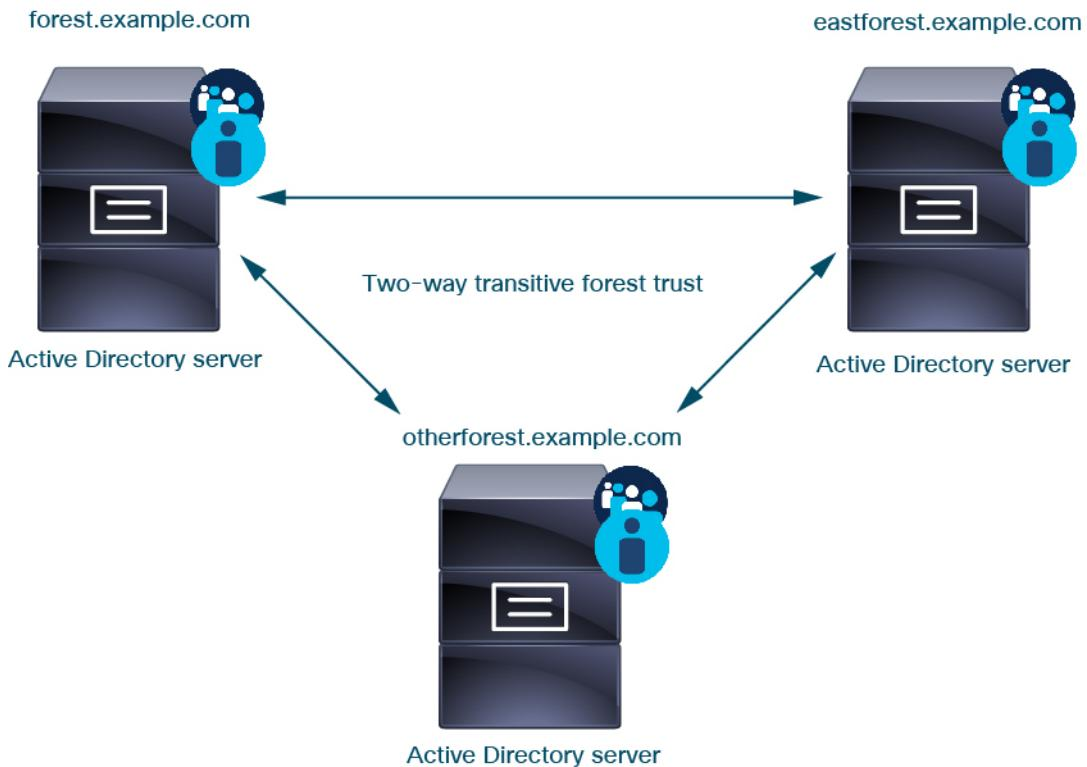
最後に、双方向の推移的なフォレストの信頼関係を持つ2フォレストシステムのユーザーとグループに ID ポリシーを適用できるように Firewall Management Center を設定することができる。各フォレストに少なくとも 1 つのドメインコントローラがあり、それぞれが異なるユーザーとグループを認証します。Firewall Management Center がこれらのユーザーとグループに ID ポリシーを適用できるようにするには、関連するユーザーを含む各ドメインを Firewall Management Center レルムとして、また各ドメインコントローラをそれぞれのレルムの Firewall Management Center ディレクトリとして設定する必要があります。
