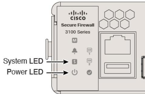
**ステップ 4** ファイアウォールの背面にあるシステム LED を確認します。緑色に点灯している場合は、電源投入診断に合格しています。
