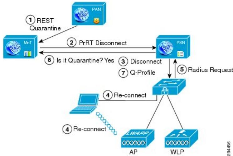
1. クライアントデバイスがワイヤレスデバイス（WLC）を通じてネットワークにログインし、隔離の REST API コールが管理ノード（PAN）からモニタリングノード（MnT）に発行されます。
