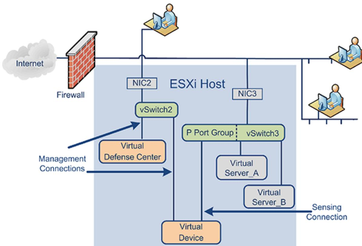
仮想デバイスの検知接続は、ネットワーク トラフィックを監視できるようにする必要があります。仮想スイッチまたは仮想インターフェイスが接続するスイッチ上のポート グループは、無差別モードのトラフィックを受け入れる必要があります。これにより、仮想デバイスは他のマシンまたはネットワーク デバイス向けのパケットを読み取ることができます。例では、P ポートグループが無差別モードのトラフィックを受け入れるように設定されています。[仮想デバイスのセンシングインターフェイスの設定](#) (4-12 ページ) を参照してください。
