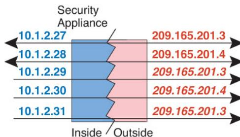
このようにスタティックルールを使用するのではなく、双方向の開始を必要とするトラフィックに1対1のルールを作成し、残りのアドレスにダイナミックルールを作成することをお勧めします。
