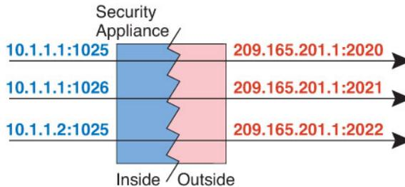
変換が継続している間、アクセスルールで許可されていれば、宛先ネットワーク上のリモートホストは変換済みホストへの接続を開始できます。実際のポートアドレスおよびマッピングポートアドレスはどちらも予測不可能であるため、ホストへの接続は確立されません。ただし、この場合は、アクセスルールのセキュリティに依存できます。
