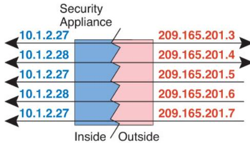
多対少または多対1コンフィギュレーションでは、マッピングアドレスよりも多くの実際のアドレスが存在します。実際のアドレスが不足するよりも前に、マッピングアドレスが不足します。双方向の開始を実現できるのは、最下位の実際の IP アドレスとマッピングプールの中でマッピングを行ったときだけです。残りの上位の実際のアドレスはトラフィックを開始できますが、これらへのトラフィックを開始できません。接続のリターントラフィックは、接続の固有の5つの要素（送信元 IP、宛先 IP、送信元ポート、宛先ポート、プロトコル）によって適切な実際のアドレスに転送されます。
