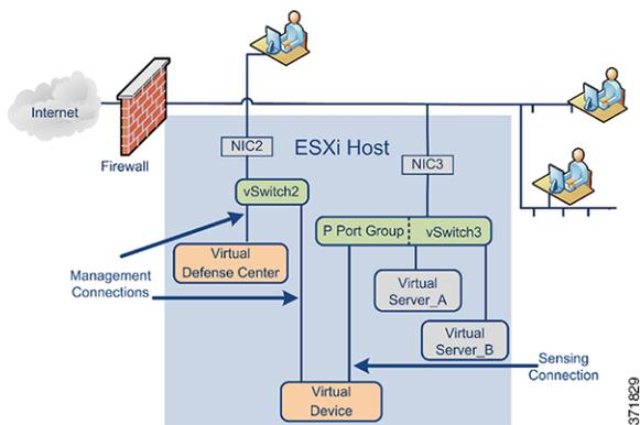
仮想デバイスの検知接続は、ネットワーク トラフィックを監視できるようにする必要があります。仮想スイッチまたは仮想インターフェイスが接続するスイッチ上のポート グループは、無差別モードのトラフィックを受け入れる必要があります。これにより、仮想デバイスは他のマシンまたはネットワーク デバイス向けの packets を読み取ることができます。例では、P ポート グループが無差別モードトラフィックを受け入れるように設定されています。[仮想デバイスのセンシングインターフェイスの設定\(13 ページ\)](#)を参照してください。
