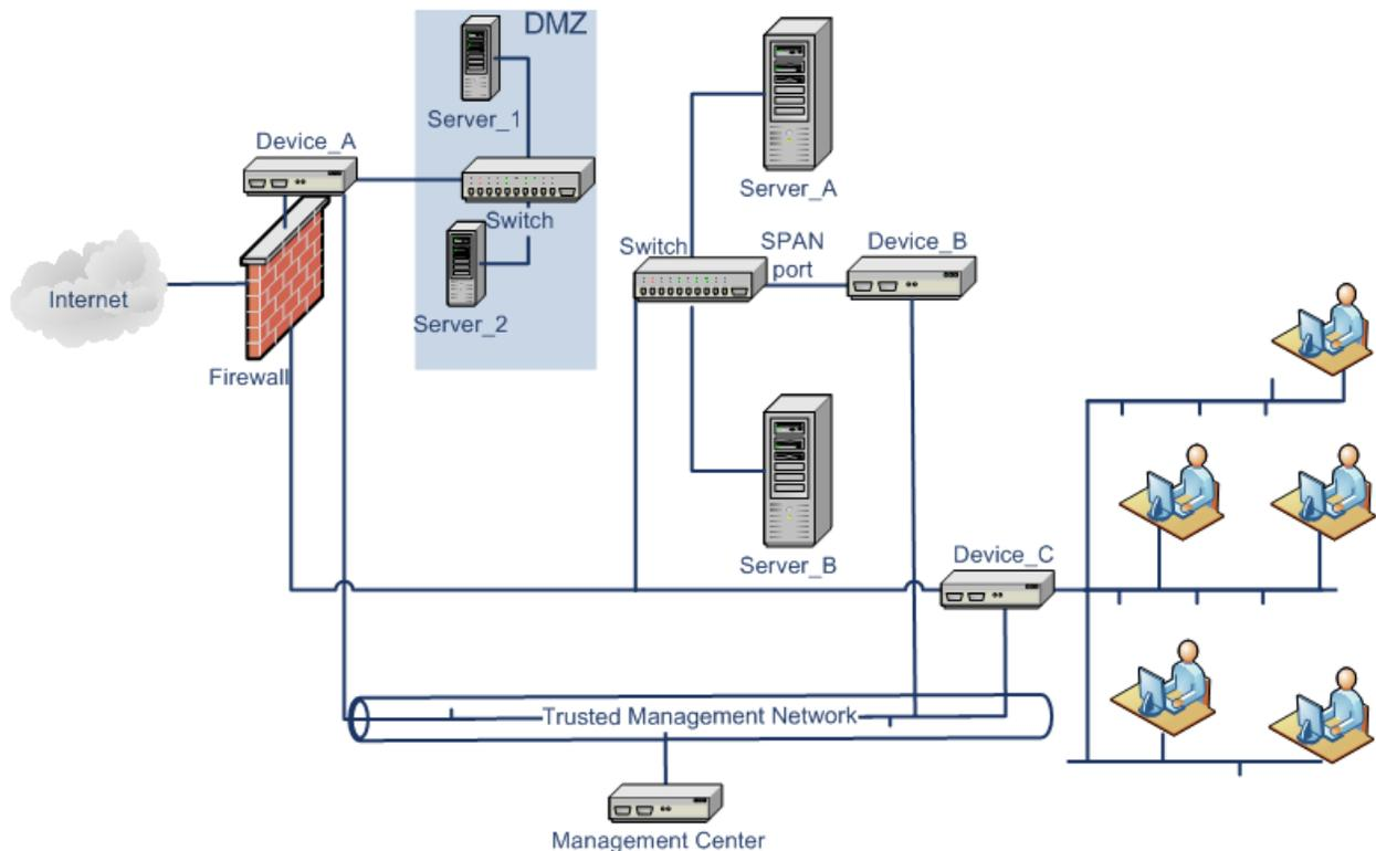
ほとんどのネットワーク スイッチでポート ミラーリングを設定して、1つのスイッチ ポート(または VLAN 全体)で発生するネットワーク パケットのコピーをネットワーク 監視接続に送信できます。主要なネットワーク 機器プロバイダーでは SPAN(スイッチ ポート アナライザ)とも呼ばれるポート ミラーリングを使用することで、ネットワーク トラフィックを監視できます。Device\_B は、Server\_A と Server\_B の間のスイッチの SPAN ポートを経由して、Server\_A と Server\_B の間のトラフィックを監視することに注意してください。
