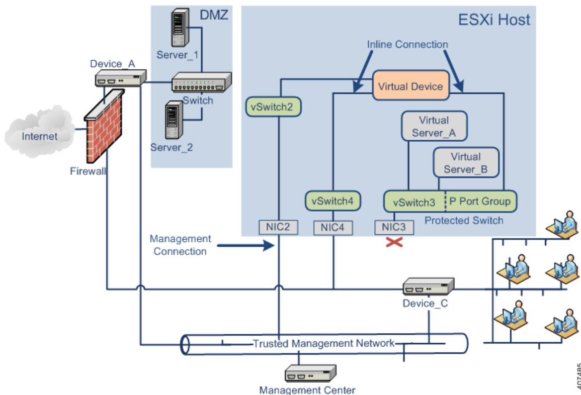
(注)すべてのトラフィックを検知するには、デバイス センシング インターフェイスが接続する仮想スイッチまたはポート グループで無差別モードトラフィックを許可します。[仮想デバイスのセンシング インターフェイスの設定 \(13 ページ\)](#)を参照してください。
