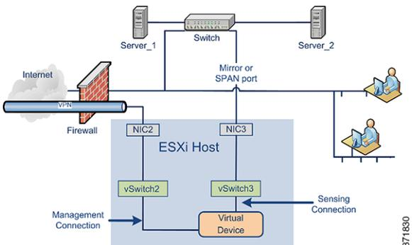
仮想デバイスの検知接続は、ネットワーク トラフィックを監視できるようにする必要があります。これを行うには、仮想スイッチまたはセンシングインターフェイスが接続するスイッチのポート グループが、無差別モードトラフィックを受け入れる必要があります。これにより、仮想デバイスは他のマシンまたはネットワーク デバイス向けの packets を読み取ることができます。この例では、vSwitch3 のすべてが無差別モードトラフィックを受け入れるように設定されています。vSwitch3 は、NIC3 を経由して SPAN ポートにも接続されているため、リモート オフィスのスイッチを通過するトラフィックも監視できます。[仮想デバイスのセンシングインターフェイスの設定\(13 ページ\)](#)を参照してください。
