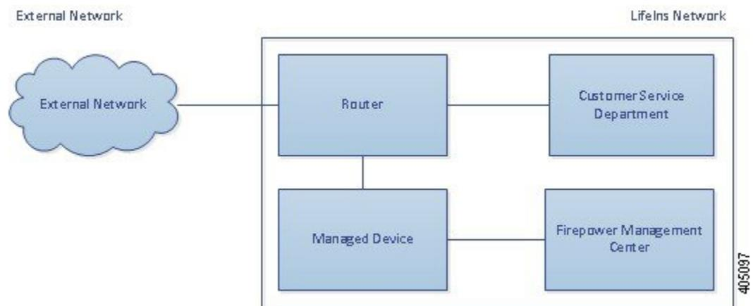
外部ネットワークからのトラフィックはLifeInsのルータに送信されます。ルータはトラフィックをカスタマー サービス部門にルーティングし、検査用にトラフィックのコピーを管理対象デバイスにミラーリングします。
