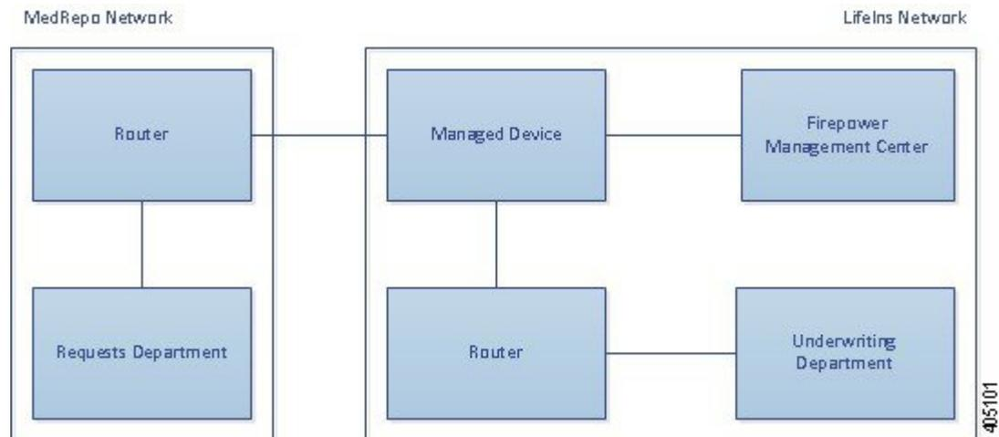
MedRepo のネットワークからのトラフィックは、MedRepo のルータに流されます。そこから LifeIns のネットワークにトラフィックがルーティングされます。管理対象デバイスがそのトラフィックを受信し、許可されたトラフィックを LifeIns のルータに転送し、また管理元の Firepower Management Center にイベントを送信します。LifeIns のルータは、トラフィックを宛先ホストにルーティングします。
