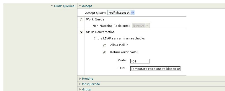
図 64: 受け入れクエリを SMTP コンバセーション中に実行するように設定
