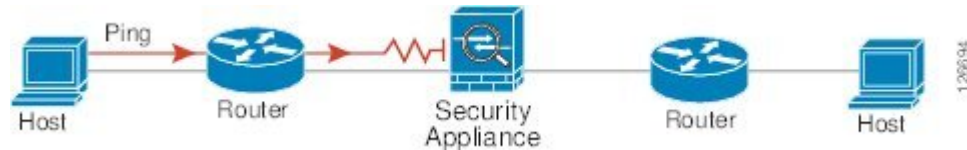
図 5: ASA のアドレス変換の問題による ping の失敗
