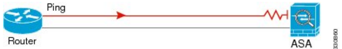
図 4: ASA の戻りルート未設定による ping の失敗
