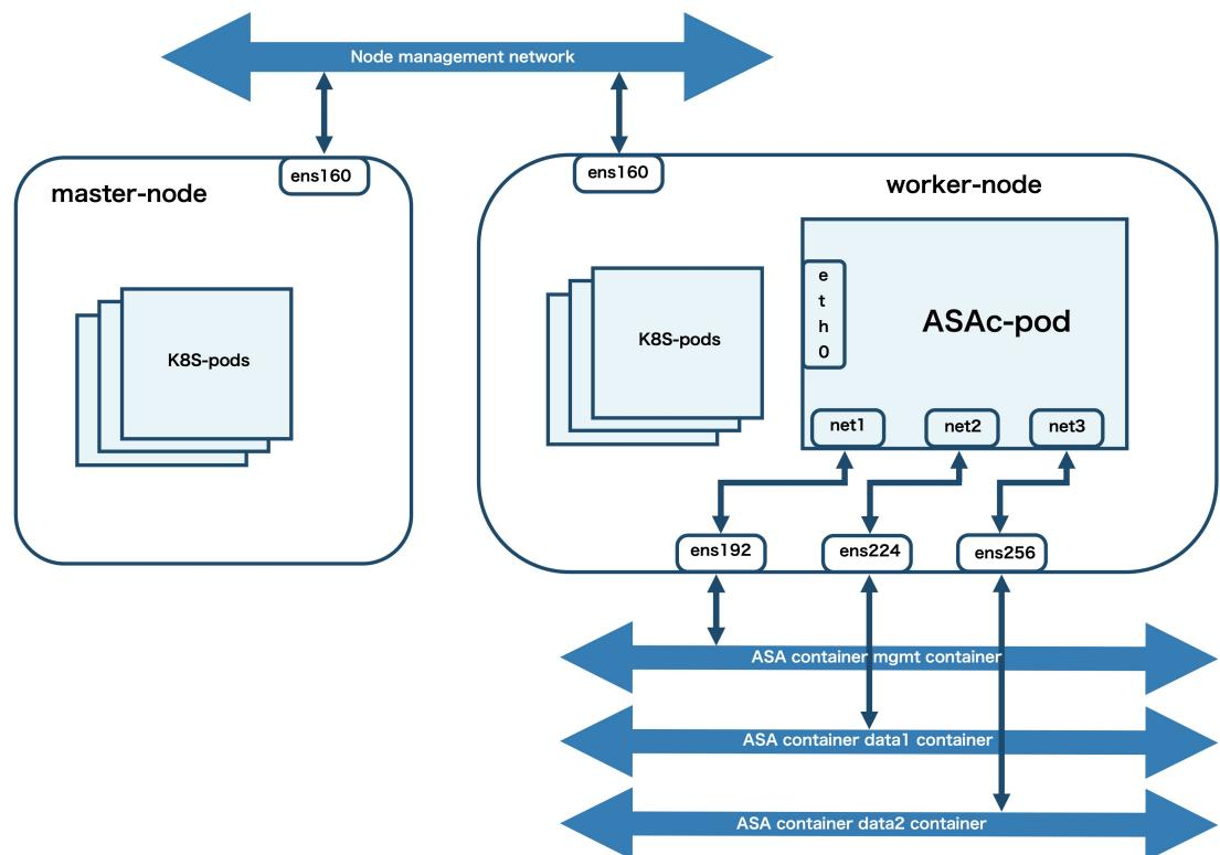
このサンプルトポロジでは、ASA コンテナ (ASAc) ポッドに 3 つの仮想ネットワークインターフェイス (net1、net2、net3) があり、ワーカーノードインターフェイス ens192、ens224、および ens256 に接続されています。これらのワーカーノードインターフェイスは、ASAc mgmt、data1、および data2 ネットワークにマッピングされます。インターフェイス ens160 は、ノード管理インターフェイスです。インターフェイス eth0 は、Calico CNI から派生しています。インターフェイス net1、net2、および net3 は、Multus macvlan CNI から派生しています。
