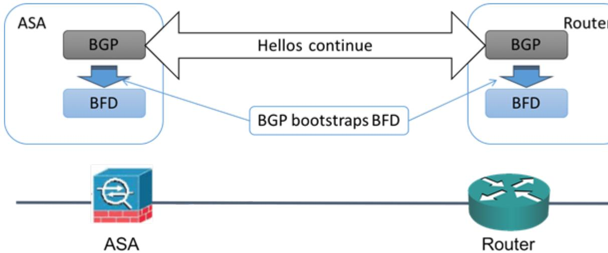
BGP は、BGP ネイバーの特定後に、そのネイバーの IP アドレスを使用して BFD プロセスをブートストラップします。BFD はそのピアを動的に検出しません。BFD は、設定されているルーティングプロトコルから、使用する IP アドレスと形成するピア関係を把握します。
