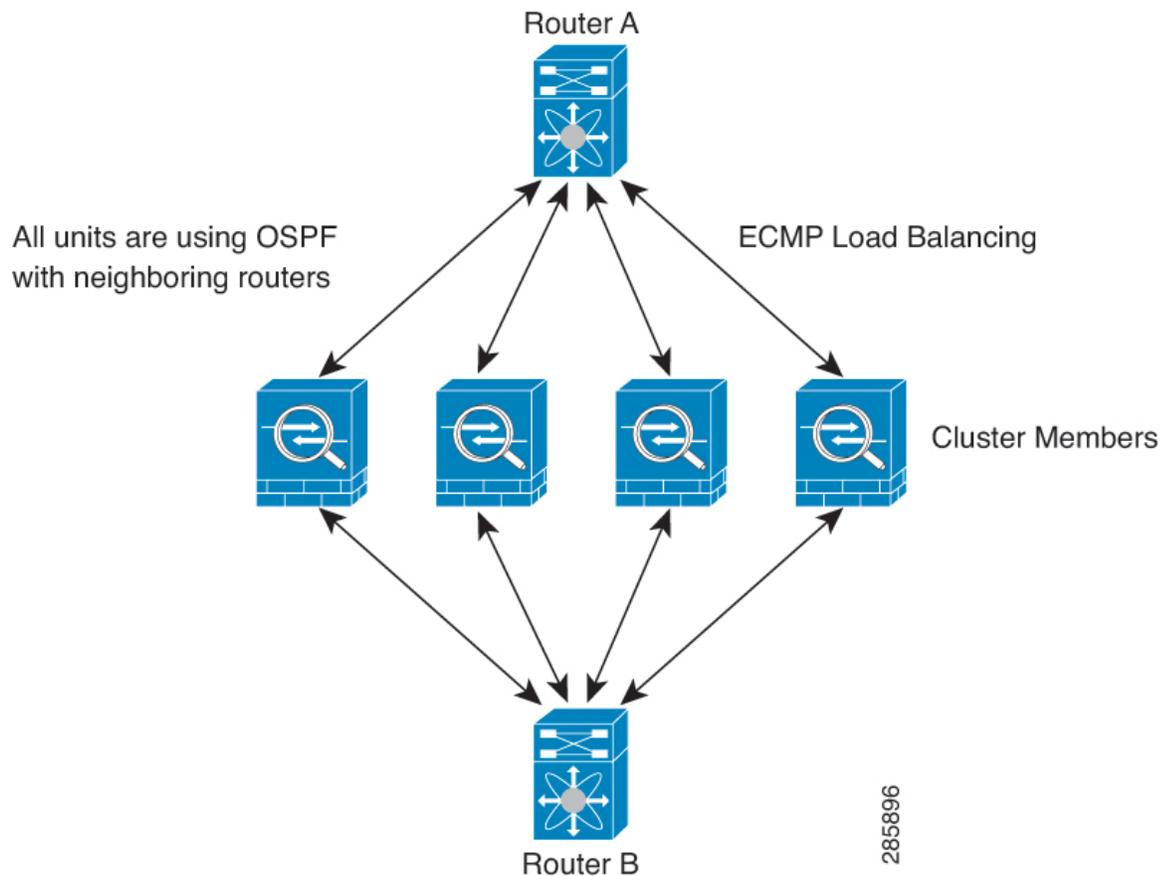
上の図では、ルータ A はルータ B への等コストパスが 4 本あることを学習します。パスはそれぞれ 1 つの ASA を通過します。ECMP を使用して、4 パス間でトラフィックのロードバランシングを行います。各 ASA は、外部ルータと通信するときに、それぞれ異なるルータ ID を選択します。
