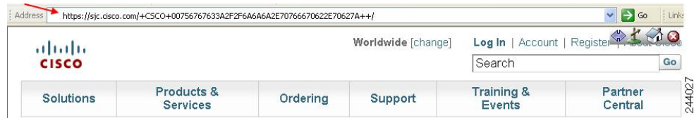
図 2: セキュリティ アプライアンスによって書き換えられ、ブラウザウィンドウに表示された同じ URL
