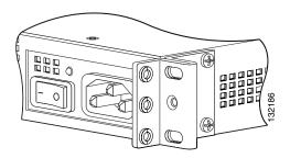
ステップ 2 付属のネジを使用して、シャーシをラックに取り付けます(図 2-3 を参照してください)。
