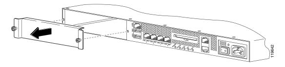
ステップ 4 スロット開口部に SSM を差し込みます (図 3-7 を参照してください)。
