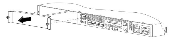
ステップ4 スロット開口部に Cisco 4GE SSM を差し込みます(図 3-3 を参照してください)。
