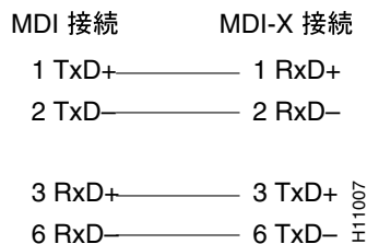
図 2-15 ハブまたはリピータに対するストレート ケーブルのピン割り当て
