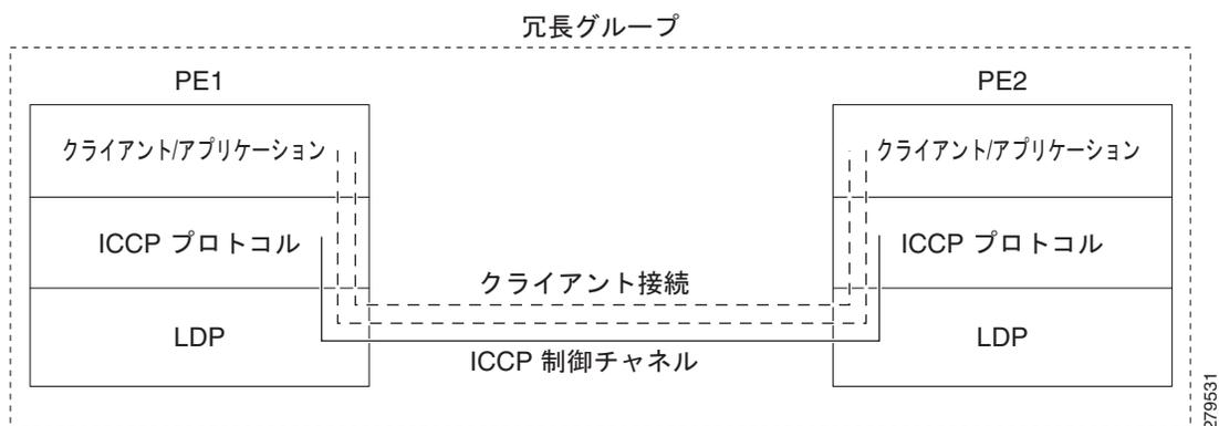
2 つの POA がシャーシ間通信プロトコル (ICCP) を使用して LDP リンクを介して相互に通信します。ICCP は、冗長グループの POA 間で LDP セッションが作成される LDP ベースの protocols であり、ICCP メッセージは LDP セッションを介して伝送されます。冗長グループの PE ルータは、シングルホップ (直接接続)、または相互にマルチホップである場合があります。ICCP プロトコルは設定を管理し、冗長グループを制御します。また、ICCP 接続を確立、維持、解除します。ICCP プロトコルは route-watch を使用して、特定の冗長グループの PE への接続をモニタリングします。これはコア分離の障害をトラッキングする役割もあります。この場合、すべてのクライアントアプリケーションに対して、障害 (コアの分離およびアクティブ PE 障害) が通知されます。
