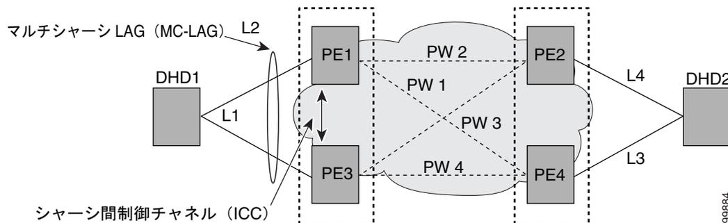
図 10 VPWS 双方向疑似回線冗長性
