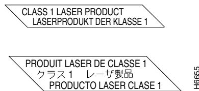
図 3-1 シングルモード ポート用クラス 1 レーザー警告ラベル
