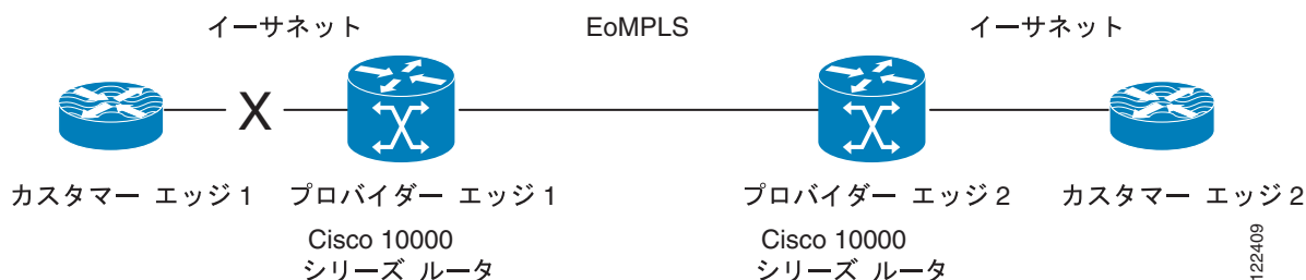
図 17-5 EoMPLS WAN のリモート リンクの停止
