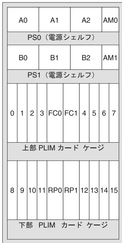
図 1 ライン カード シャーシ前面 (PLIM 側) のスロット番号
