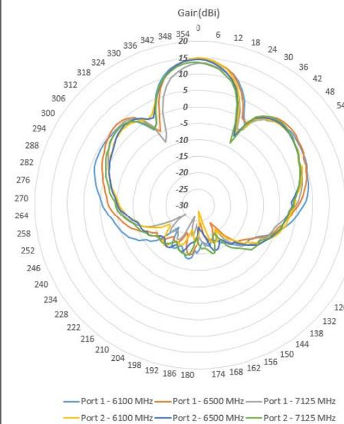
図 8: 6 GHz 放射パターン - 垂直面 (Y-Z)
