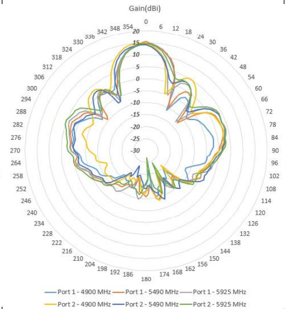
図 7: 6 GHz 放射パターン - 水平面 (X-Z)
