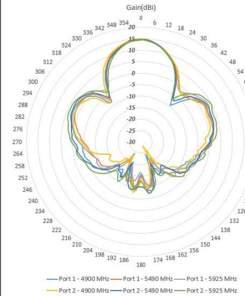
図 6: 5 GHz 放射パターン - 垂直面 (Y-Z)
