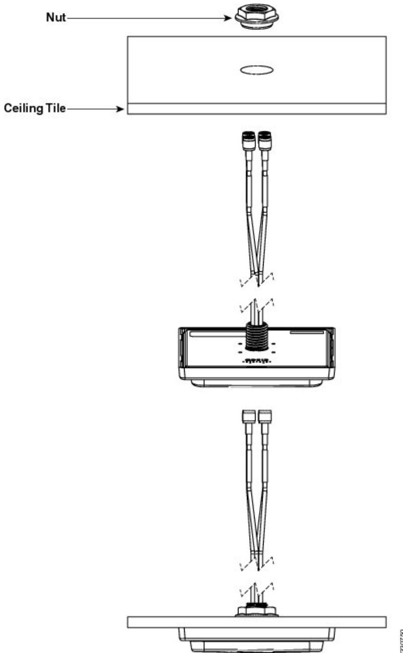
(注) 天井タイルにアンテナを取り付ける場合は、ゴム製ガスケットを使用しないでください。天井タイルへの取り付けには、ガスケットは必要ありません。
