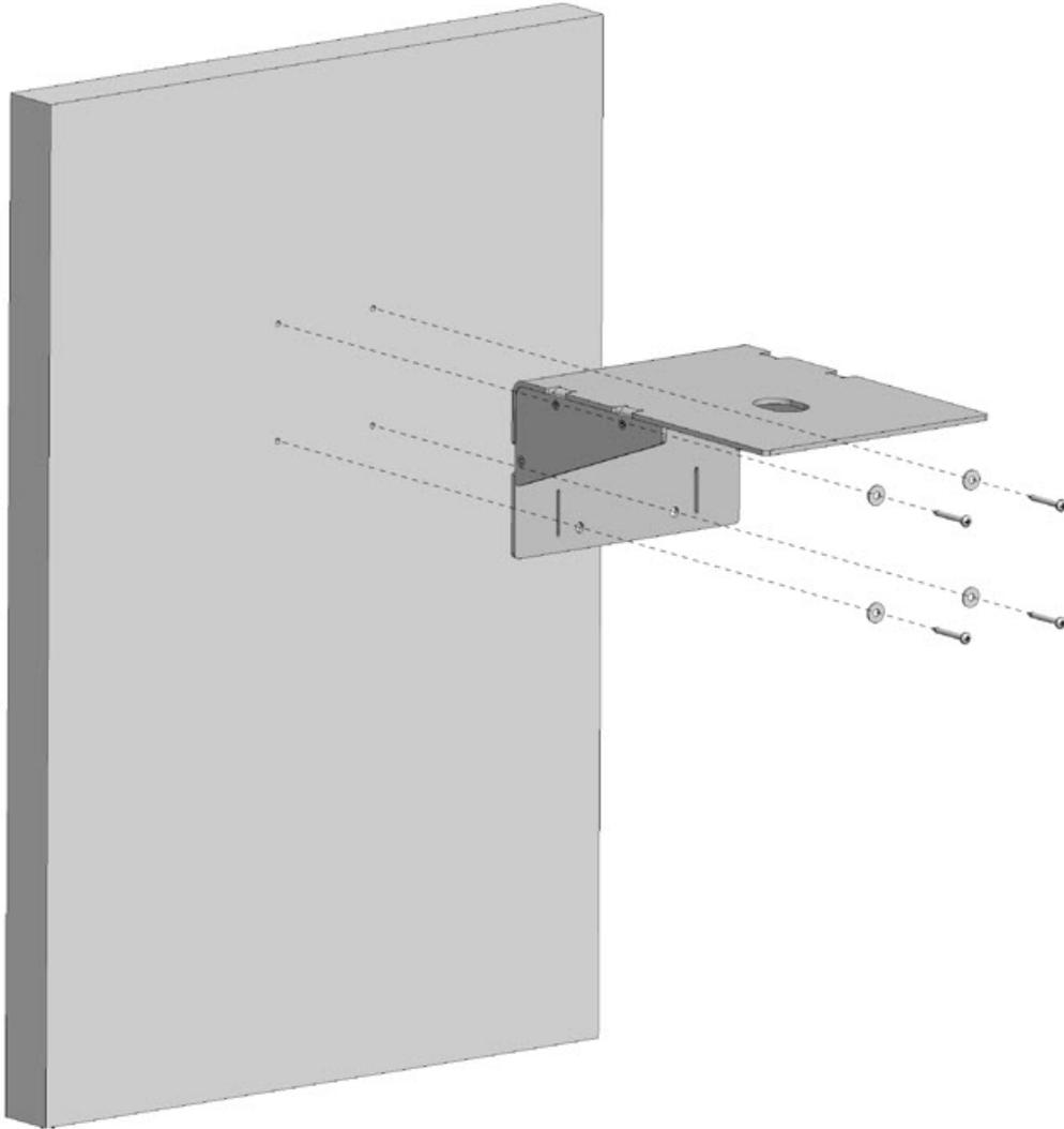
**ステップ 3** 付属のネジと座金を使用して固定して締め付けます。
