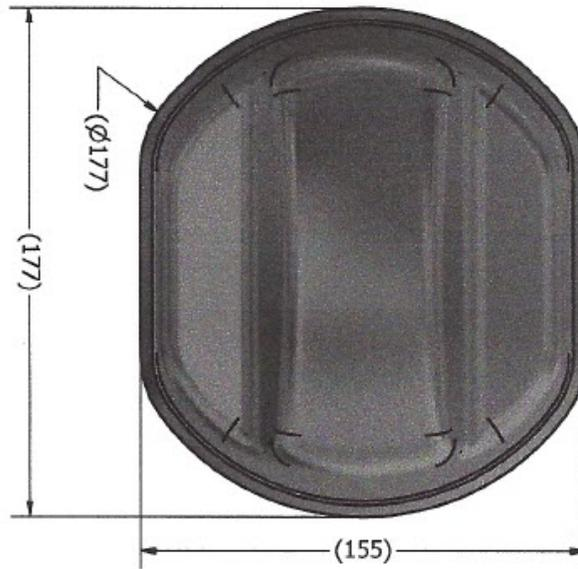
図 3: アンテナの機械図 (側面)
