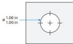
**ステップ 3** 取り付け時のケーブルの損傷やVHB接着剤の汚染を防ぐために、穴にバリや鋭利な先端がないことを確認してください。
