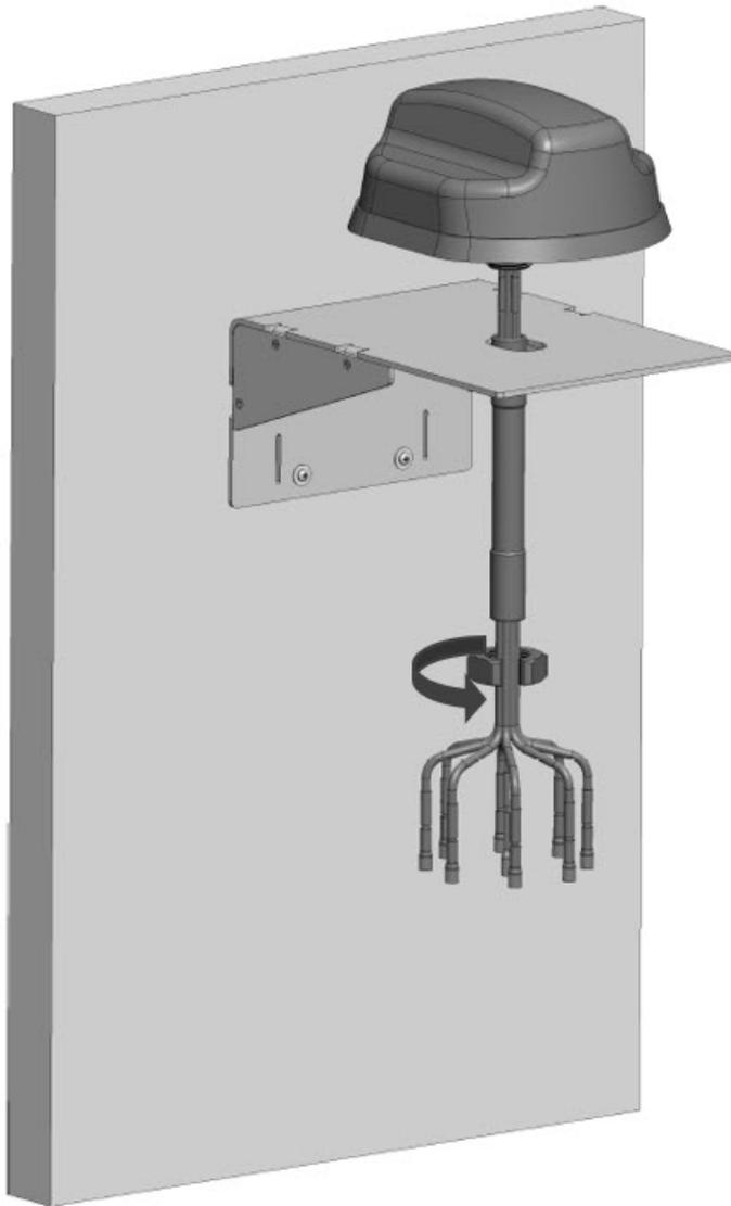
**ステップ 9** 外側のゴム製ガスケットを目視検査します。取り付け面とレドームが適切に封止されていることを確認してください。ロックナットに止めねじによる固定機能がある場合は、上記のようにロックナットを締め付け、止めねじを 3.5 Nm (2.2 lbf) のトルクで締め付けます。
