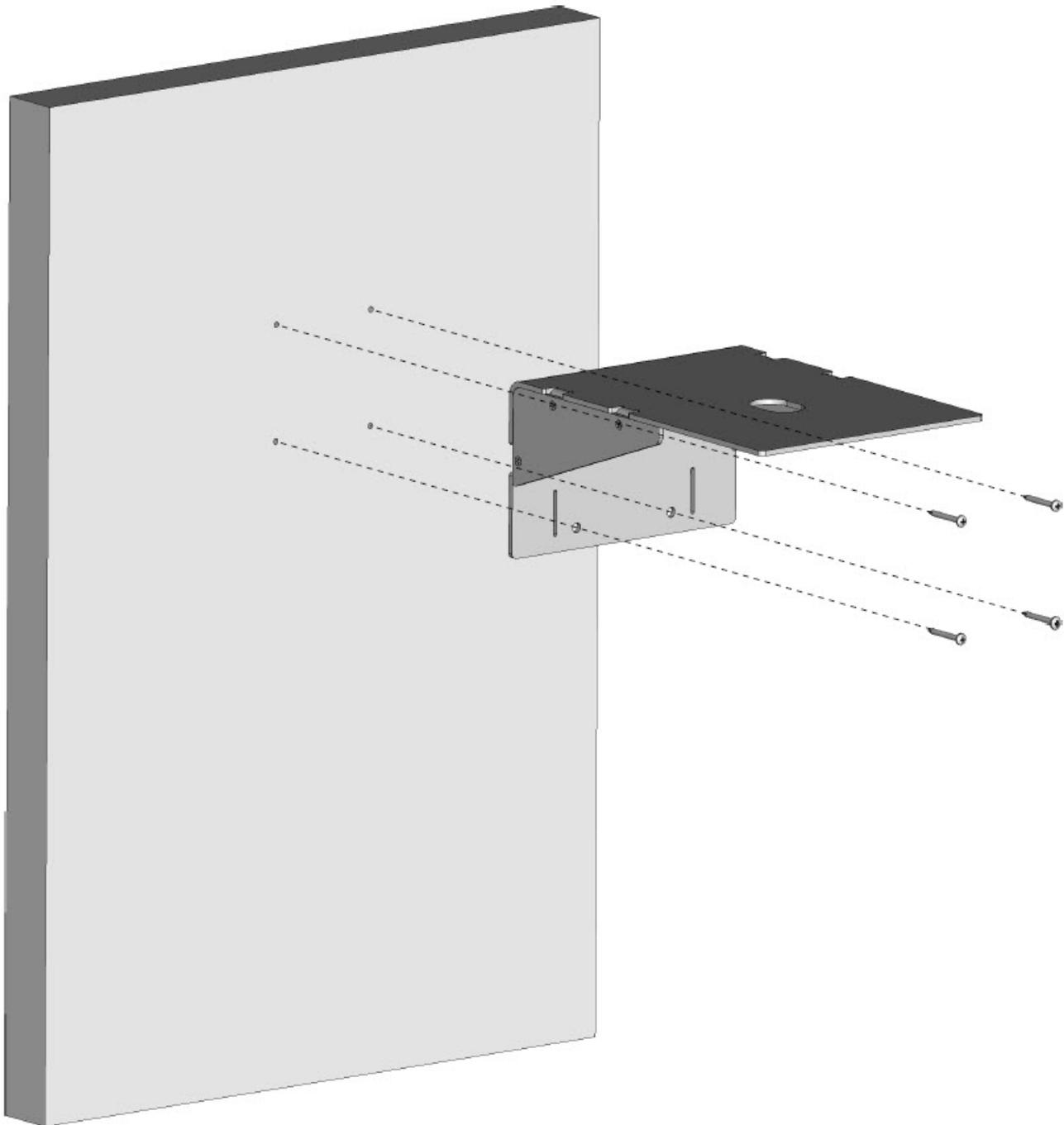
**ステップ 3** 4本のコンクリートネジを使用して、3/16 インチの六角ドライバで固定して締めます。
