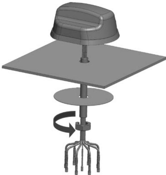
**ステップ 8** 外側のゴム製ガスケットを目視検査して、取り付け面とレドームが適切に封止されていることを確認します。ロックナットに止めねじによる固定機能がある場合は、上記のようにロックナットを締め付け、止めねじを 3.5 Nm (2.2 lbft) のトルクで締め付けます。
