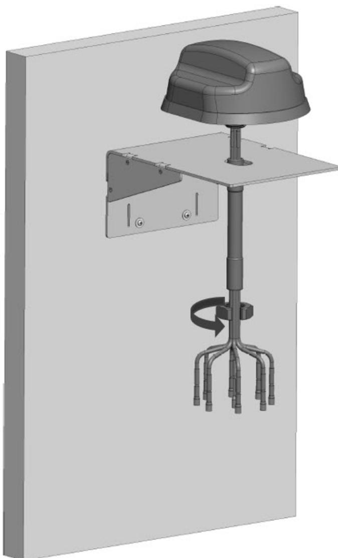
**ステップ 9** 外側のゴム製ガスケットを目視検査します。取り付け面とレドームが適切に封止されていることを確認してください。ロックナットに止めねじによる固定機能がある場合は、上記のようにロックナットを締め付け、止めねじを 3.5 Nm (2.2 lbft) のトルクで締め付けます。
