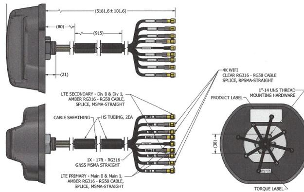
図 4: アンテナの機械図 (下)
