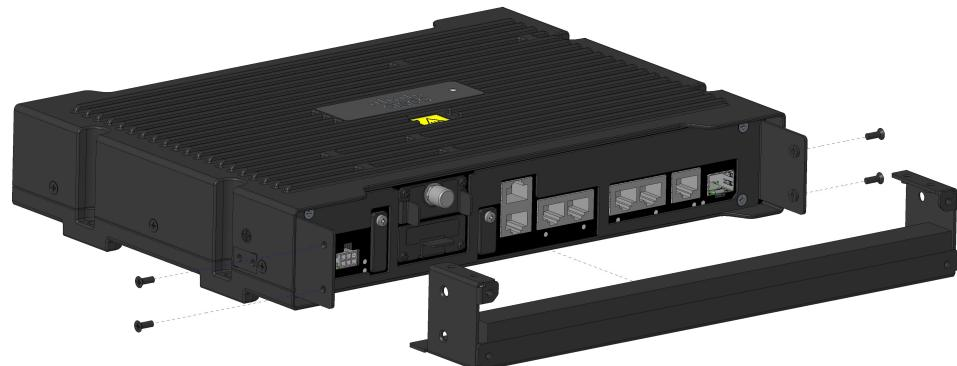
ステップ4 下部カバーを取り付けた後、電源ケーブルおよびその他のすべてのケーブルを差し込みます。
