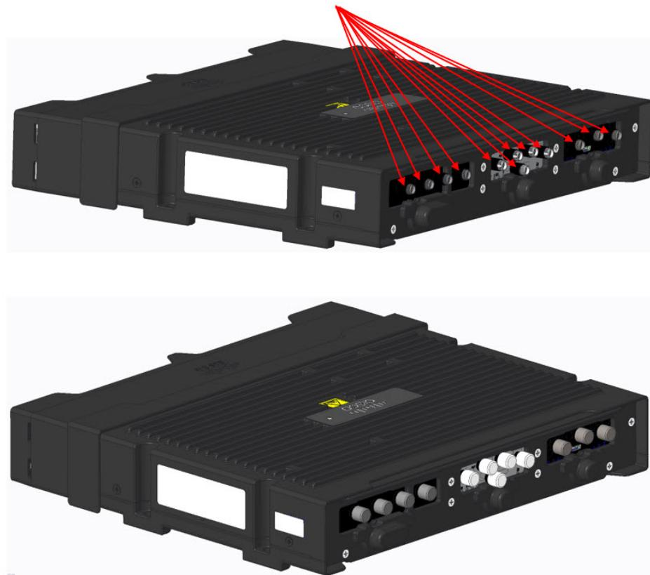
**ステップ4** カバーを取り付けたら、必要に応じてアンテナケーブルをプラガブルモジュールに取り付けます。
