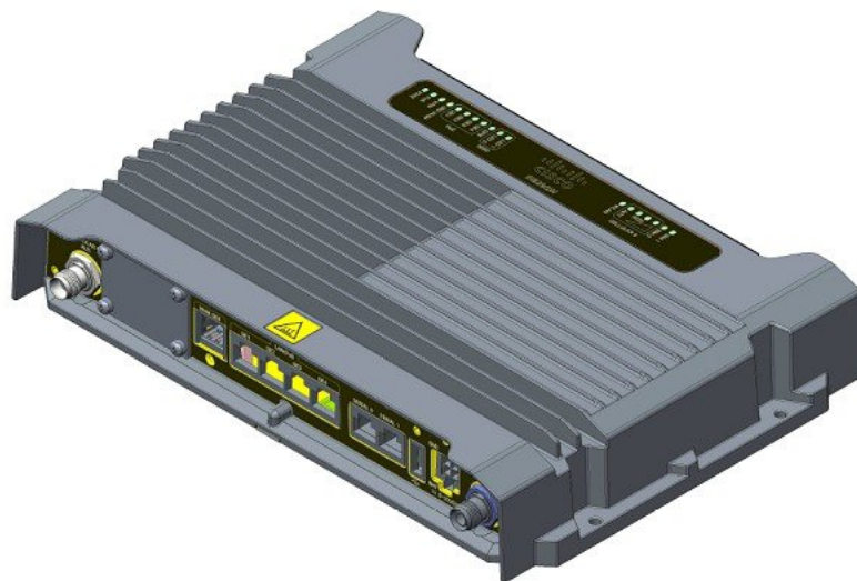
図 2 : Cisco IR829 シングルモデムの前面パネル (2 ページ) に Cisco IR829 シングルモデムの前面パネルの詳細を示します。
