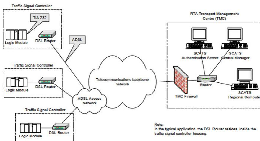
上の図では、IR1101 が DSL ルータの役割を果たし、Traffic Signal Controller (TSC; 交通信号制御機) がシリアルインターフェイスを介して接続されています。TSCに接続すると、ルータは
