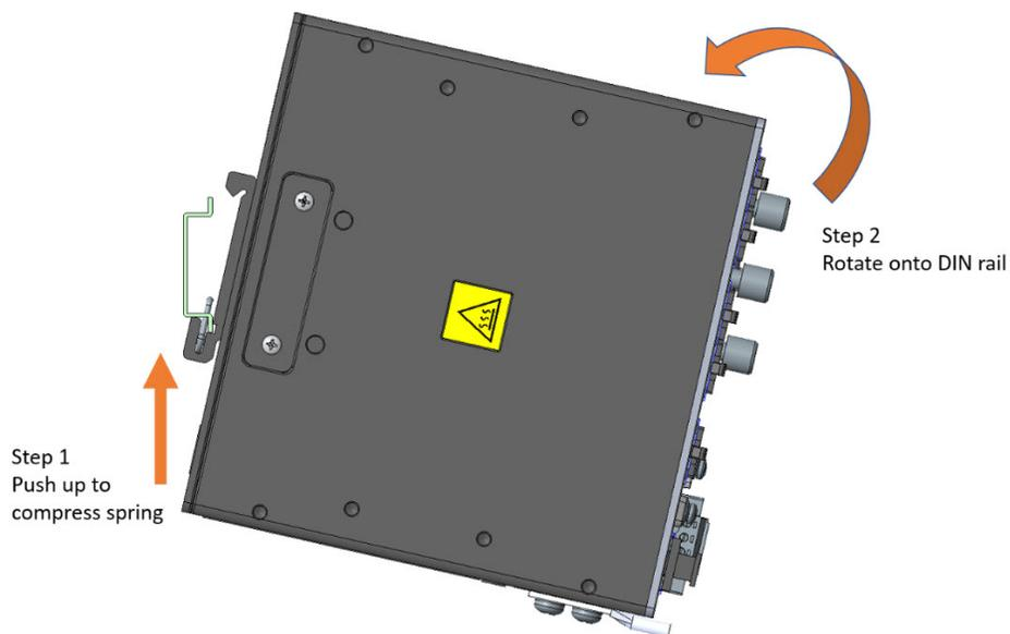
**ステップ 2** DIN クリップの上部フックが DIN レールの上部に固定されるようにルータを回転させます。次の図を参照してください。
