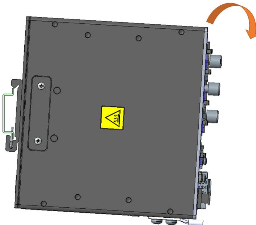
**ステップ3** ルータを DIN レールから下ろして取り外します。次の図を参照してください。
