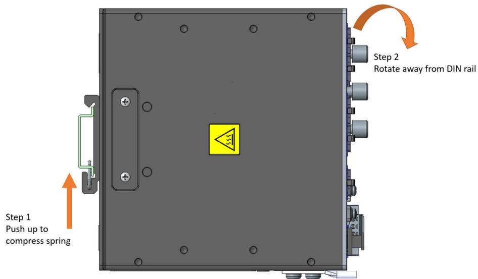
**ステップ2** ルータの上部を持ち、DIN レールから離れるように回転させます。次の図を参照してください。
