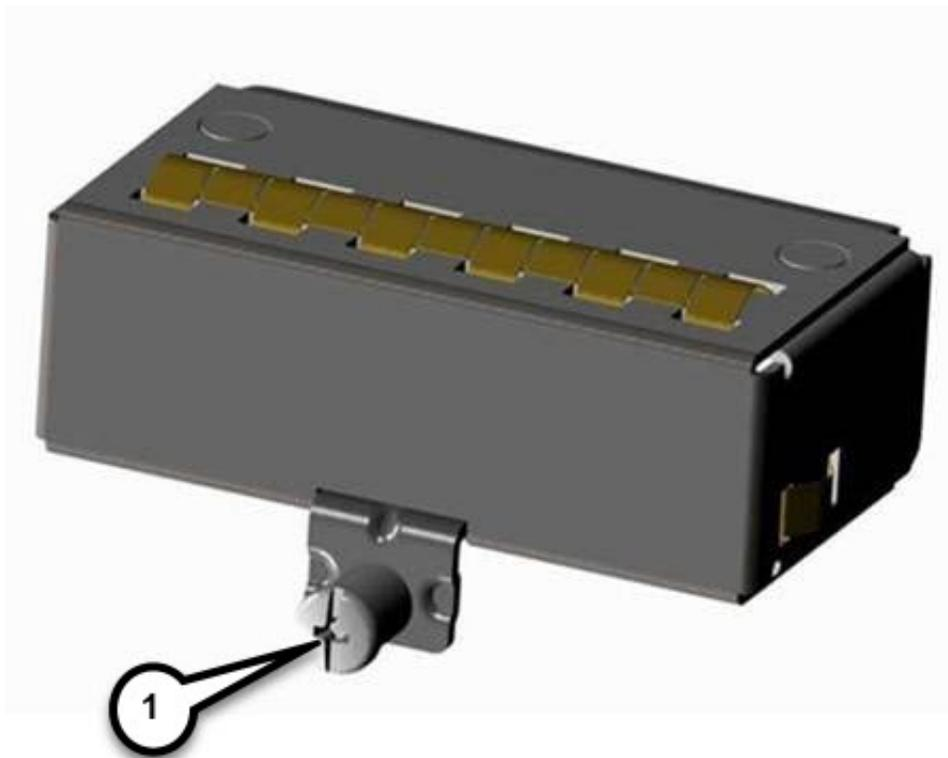
**ステップ 2** ブランクプレートをデバイスから引き抜きます。
