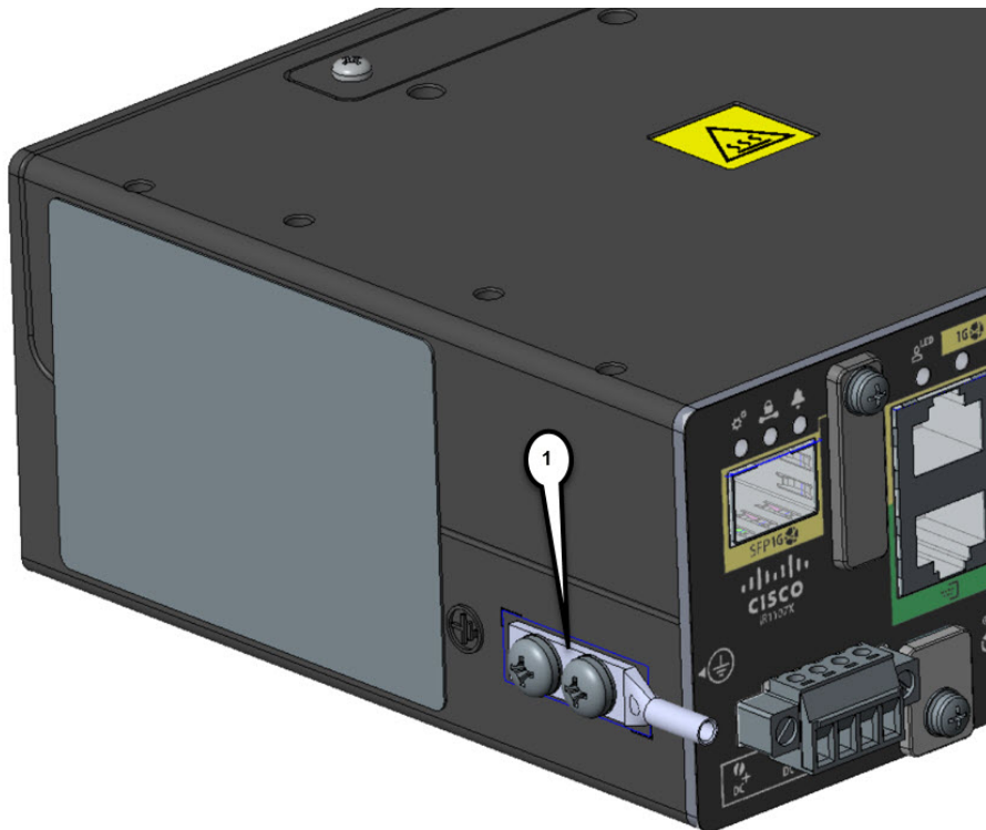
図 19: シャーシアース接続部
