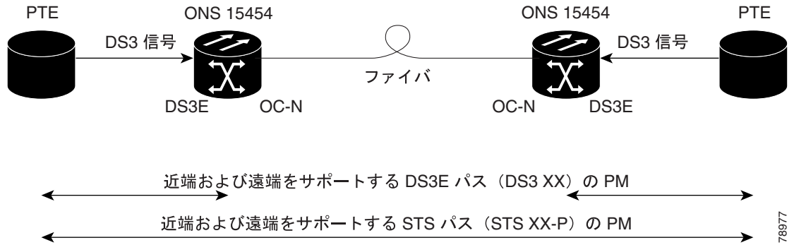
図 15-10 DS3-12E および DS3N-12E カードのモニタリング対象の信号タイプ
