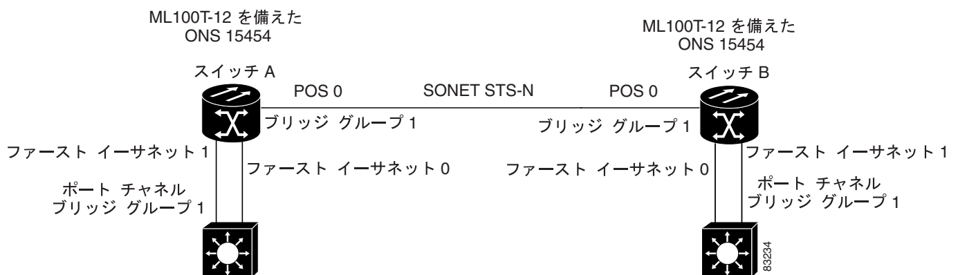
図 10-1 EtherChannel の設定例
