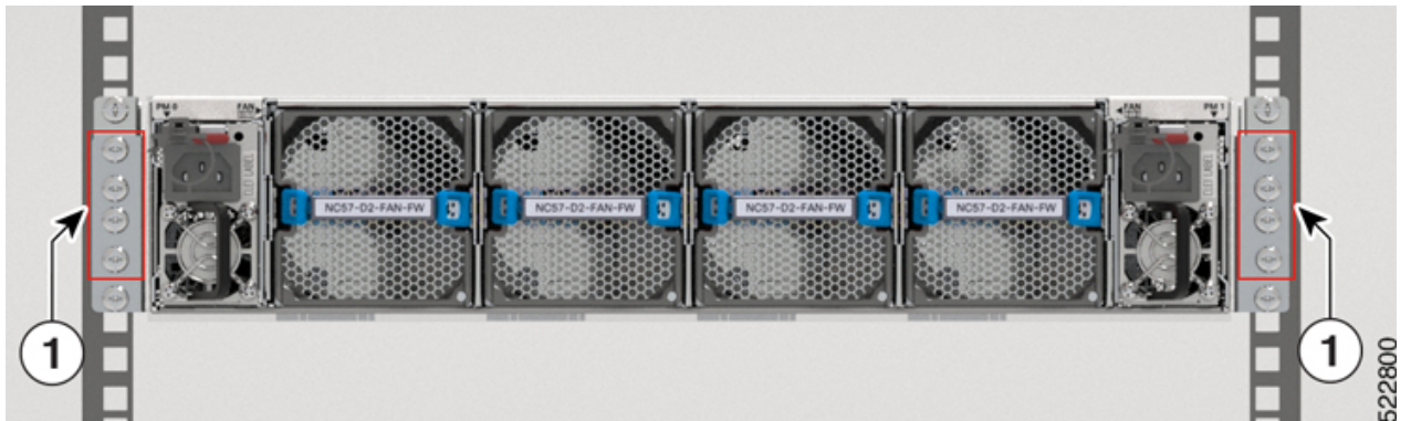
図 75: スライダブラケットからのネジの取り外し - ポート側排気構成
