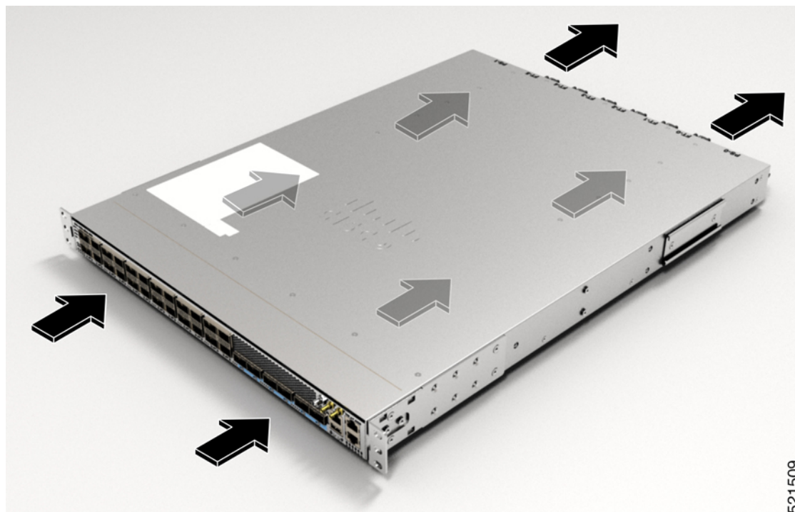
図 28: ポート側排気エアフローの方向
