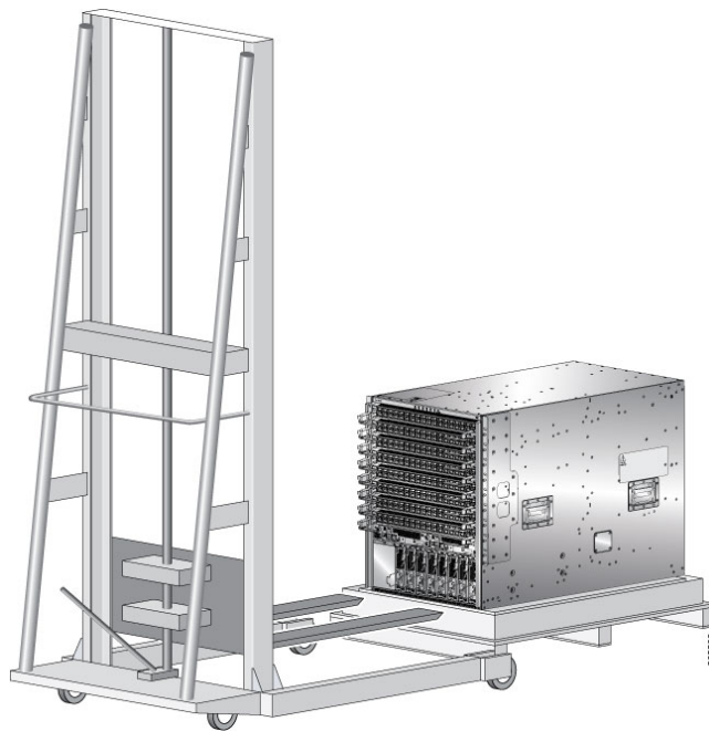
図 12: リフト装置をパレット上のシャーシの前に配置
