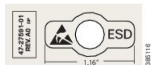
図 2: Cisco ASR 9910 ルータシャーシの静電気防止用ラベル情報
