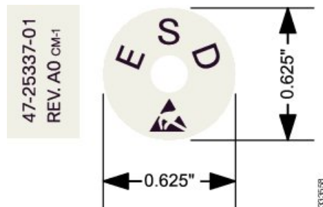
図 2: Cisco ASR 9910 ルータシャーシの静電気防止用ラベル情報
