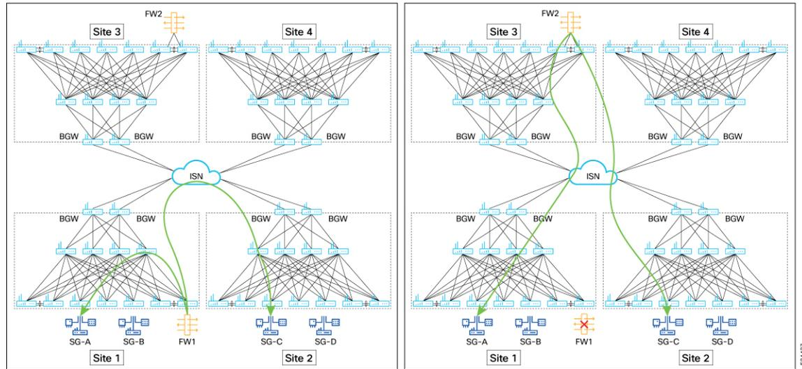
サービスチェーンが1つのサイトにのみ存在するサービスチェーンインスペクションを使用したサイト間ワークロード。順方向フローと逆方向フローの両方が同じチェーンを通過する必要があります。サービスチェーンに障害が発生した場合は、順方向と逆方向の両方のフローに対して、サードサイトのサービスチェーンへの後続フェールオーバーが必要です。
