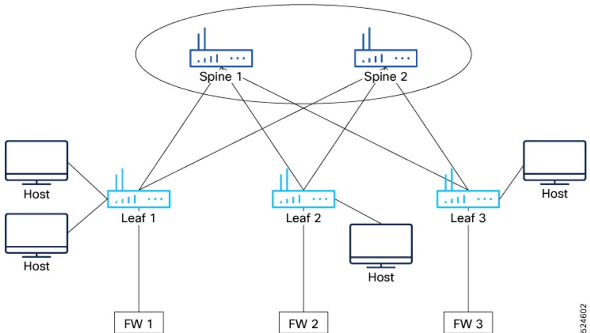
次に、サービスチェーンの一部であるサービスとして3つのファイアウォールを持つ構成例を示します。各ファイアウォールは、複数のサービスエンドポイントで実装されます。
