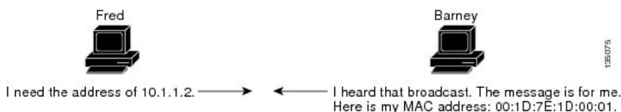
宛先デバイスが、別のデバイスを挟んだりリモートネットワーク上にあるときは、同じ処理が行われますが、データを送信するデバイスが、デフォルトゲートウェイの MAC アドレスを求める ARP 要求を送信する点が異なります。アドレスが解決され、デフォルトゲートウェイがパケットを受信した後に、デフォルトゲートウェイは、接続されているネットワーク上で宛先の IP アドレスをブロードキャストします。宛先デバイスのネットワーク上のデバイスは、ARP を使用して宛先デバイスの MAC アドレスを取得し、パケットを配信します。ARP はデフォルトでイネーブルにされています。
