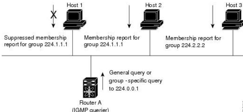
下の図では、ルータ A（サブネットの代表 IGMP クエリア）は、すべてのホストが含まれる 224.0.0.1 ホストマルチキャストグループに定期的にクエリメッセージを送信して、マルチキャストデータを受信するホストを検出します。グループメンバーシップタイムアウト値を設定できます。指定したタイムアウト値が経過すると、ルータはサブネット上にグループのメンバーまたは送信元が存在しないと見なします。
