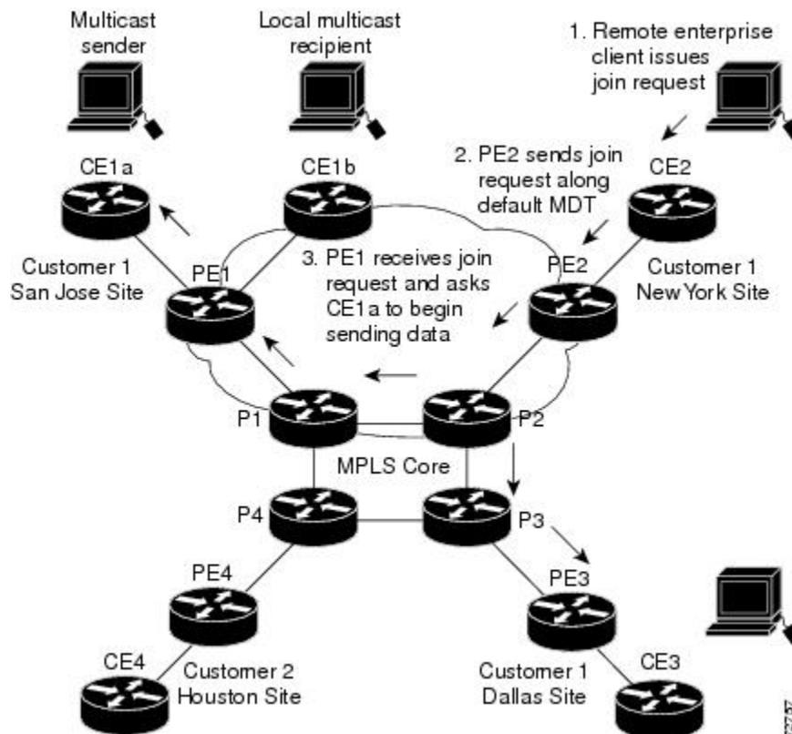
CE ルータ (CE1a) が関連する PE ルータ (PE1) へマルチキャストデータの送信を開始すると、PE ルータ (PE1) は、デフォルト MDT に沿ってマルチキャストデータを送信します。PE1 はデータ MDT を作成し、データ MDT に関する情報を含むデフォルト MDT を使用して、すべてのルータにメッセージを送信し、3 秒後、データ MDT を使用して、その特定のストリームのマルチキャストデータを送信し始めます。この送信元に関する受信先は PE2 だけにあるので、PE2 だけがデータ MDT に加入し、データ MDT でトラフィックを受信します。(データ MDT が設定されず、デフォルト MDT のみが設定されている場合、すべてのカスタマー サイトが不要なトラフィックを受信することになります)。PE ルータは、デフォルト MDT を介して他の PE ルータと PIM 関係を維持するとともに、直接接続された P ルータとの PIM 関係をも維持します。
