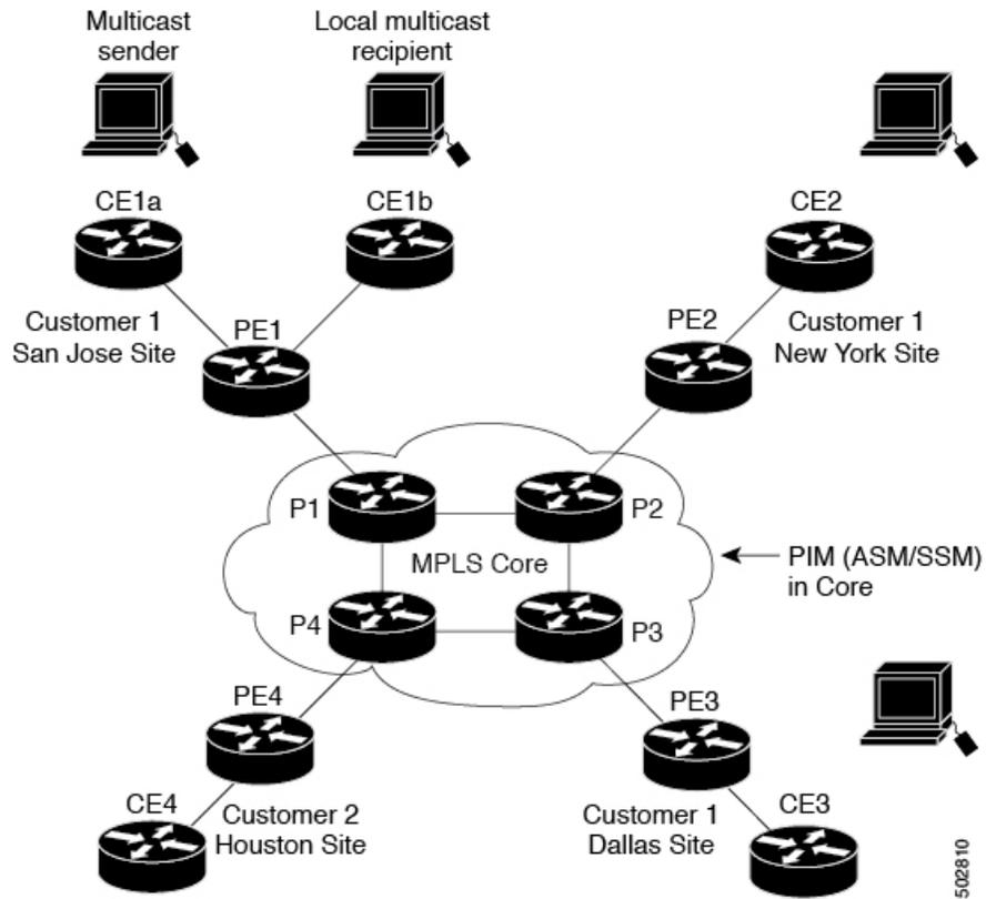
New York の従業員がマルチキャストセッションに参加します。New York のサイトに関連付けられている PE ルータは、カスタマーのマルチキャスト ドメインのデフォルト MDT を介して転送される加入要求を送信します。PE1 は、マルチキャストセッションの送信元に関連付けられている PE ルータであり、この要求を受信します。次の図は、PE ルータが、マルチキャスト送信元 (CE1a) と関連付けられた CE ルータに要求を転送することを示しています。
