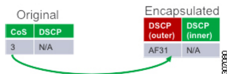
図 38: レイヤ 2 フレームから VXLAN 外部ヘッダーへの優先順位のコピー
