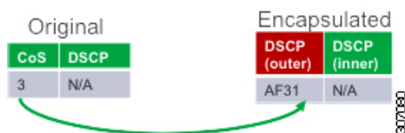
図 3: レイヤ 2 フレームから VXLAN 外部ヘッダーへの優先順位のコピー
