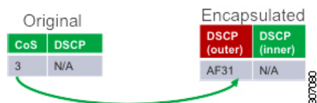
図 38: レイヤ 2 フレームから VXLAN 外部ヘッダーへの優先順位のコピー
