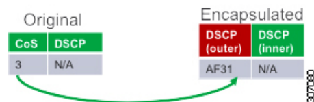
図 37: レイヤ 2 フレームから VXLAN 外部ヘッダーへの優先順位のコピー
