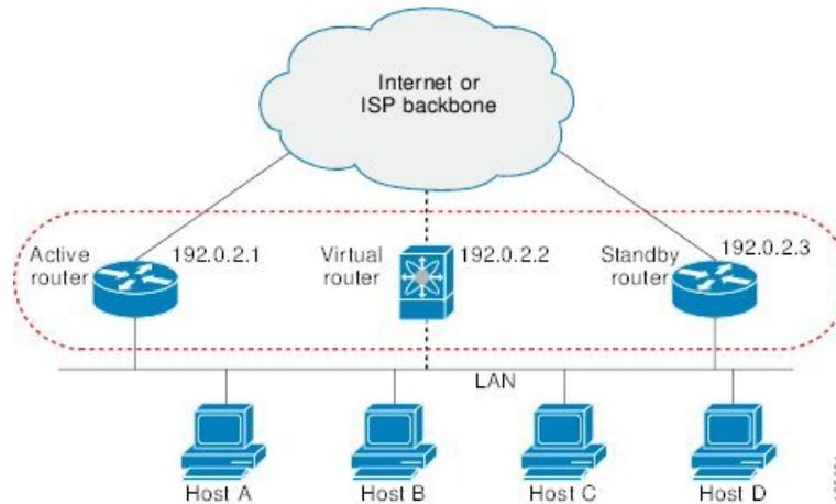
仮想ルータは物理的には存在しませんが、相互にバックアップするように設定されたインターフェイスにとって、共通のデフォルトルータになります。アクティブルータの IP アドレスを使用して、LAN 上でホストを設定する必要はありません。代わりに、仮想ルータの IP アドレス（仮想 IP アドレス）をホストのデフォルトルータとして設定します。アクティブルータが設定時間内に hello メッセージを送信できなかった場合は、スタンバイルータが引き継いで仮想アドレスに応答し、アクティブルータになってアクティブルータの役割を引き受けます。ホストの観点からは、仮想ルータは同じままです。
