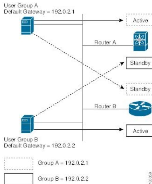
図には、2台のルータ（AおよびB）と2つの HSRP グループが示されています。ルータAはグループAのアクティブルータですが、グループBのスタンバイルータです。同様に、ルータBはグループBのアクティブルータであり、グループAのスタンバイルータです。両方のルータがアクティブのままの場合、HSRPは両方のルータにまたがるホスト。どちらかのルータで障害が発生すると、残りのルータが引き続き、両方のホストのトラフィックを処理します。
