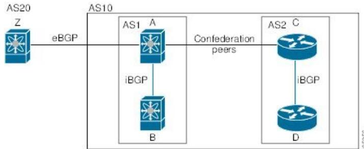
この例では、AS10 が 2 つの AS (AS1 および AS2) に分割されています。各サブ AS はフルメッシュですが、サブ AS 間のリンクは 1 つだけです。AS コンフェデレーションを使用することによって、図「AS 連合」のフルメッシュ自律システムに比べて、リンク数を少なくできます。
