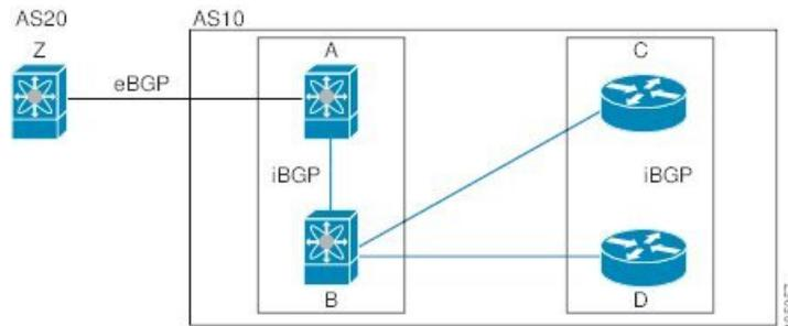
ルートリフレクタおよびそのクライアントピアは、クラスタを形成します。ルートリフレクタのクライアントピアとして動作するように、すべてのiBGPピアを設定する必要はありません。ただし、完全なBGPアップデートがすべてのピアに届くように、非クライアントピアはフルメッシュとして設定する必要があります。
