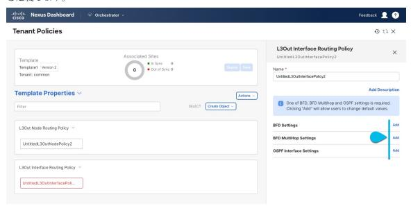
• **BFD 設定** – ピアリングルータ 接続のサポートのために構成されている ACI ファブリック境界線 リーフ スイッチの転送の失敗の検出を提供します。
