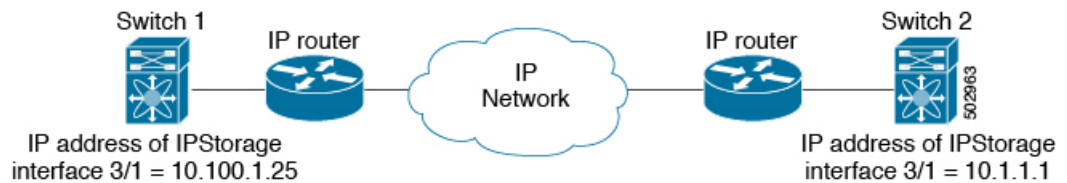
図 6: 各 IPStorage インターフェイスへのプロファイルの割り当て
