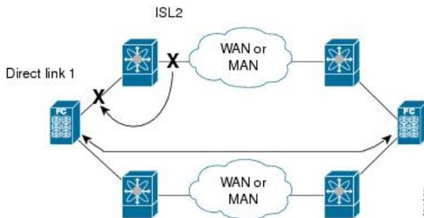
ポートトラッキング機能は、トポロジの変化を引き起こし、接続デバイスを接続しているリンクをダウンさせる障害を監視し、検出します。この機能をイネーブルにして、リンク対象ポートとトラッキング対象ポートを明示的に設定すると、Cisco NX-OS ソフトウェアはトラッキング対象ポートを監視してリンク状態の変化を検出した場合、リンク対象ポートの動作ステートを変更します。
