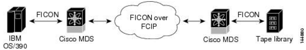
Figure 6: スタンドアロン IBM-Virtual Tape Server (VTS) /STK-Virtual Shared Memory (VSM) にアクセスするホスト
