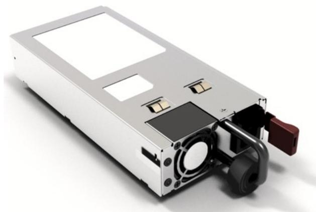
電源装置は冗長モードで動作できます。その場合、それぞれの電源装置は容量の約50パーセント、すなわち60パーセント以下、40パーセント以上で動作します。1台の電源装置が故障した場合は、もう一方の電源装置がシステム全体の電力を単独で供給できます。これはデフォルトの推奨モードです。
