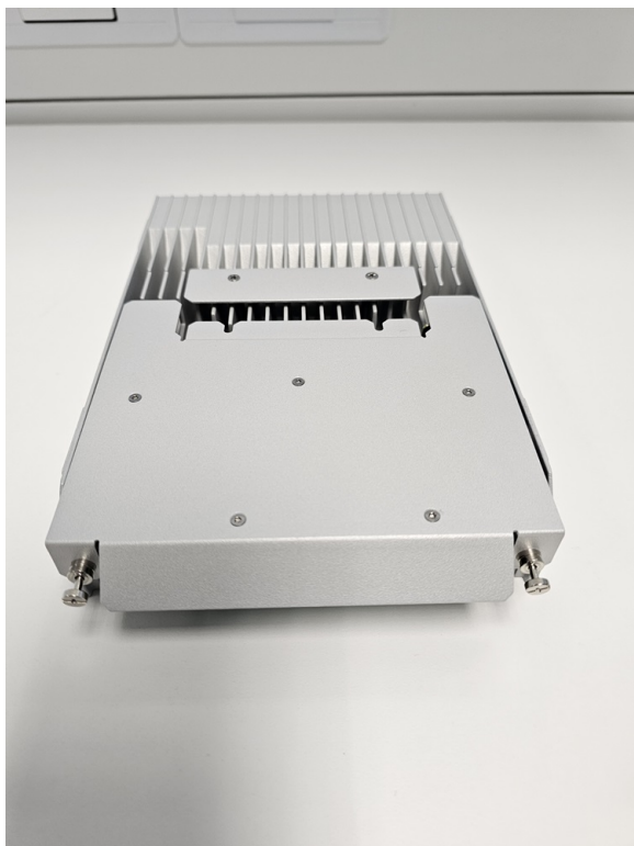
図 5: 交換用ファントレイをモジュールにスライドさせる 10G
